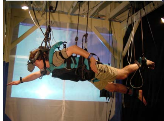
Equipamento de realidade virtual que simula a ação de nadar e mergulhar, desenvolvido por Sidney Fels, da University of British Columbia e colaboradores. Acima, o jogador e, abaixo, o cenário virtual
